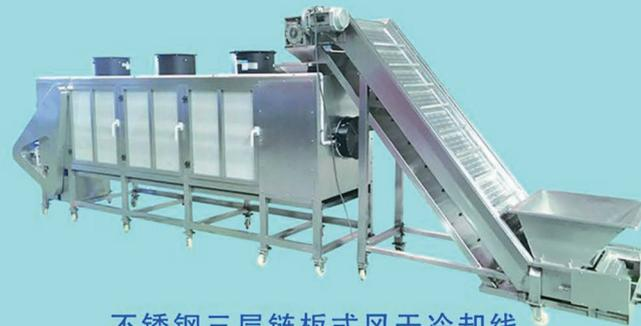
不锈钢三层链板式风干冷却线
