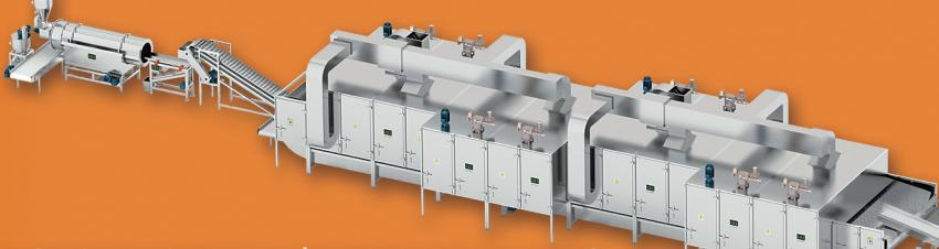
热风双循环带式干燥机 HOT AIR DOUBLE CYCLE BELT DRYER
